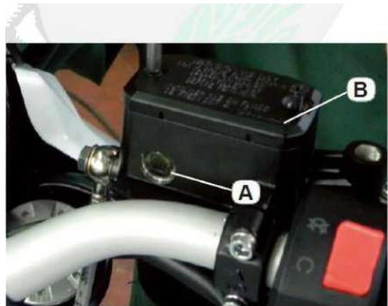
★ Si el nivel de líquido está por debajo del límite inferior, añada líquido de frenos al depósito hasta que el nivel alcance la línea de nivel alto [A].
