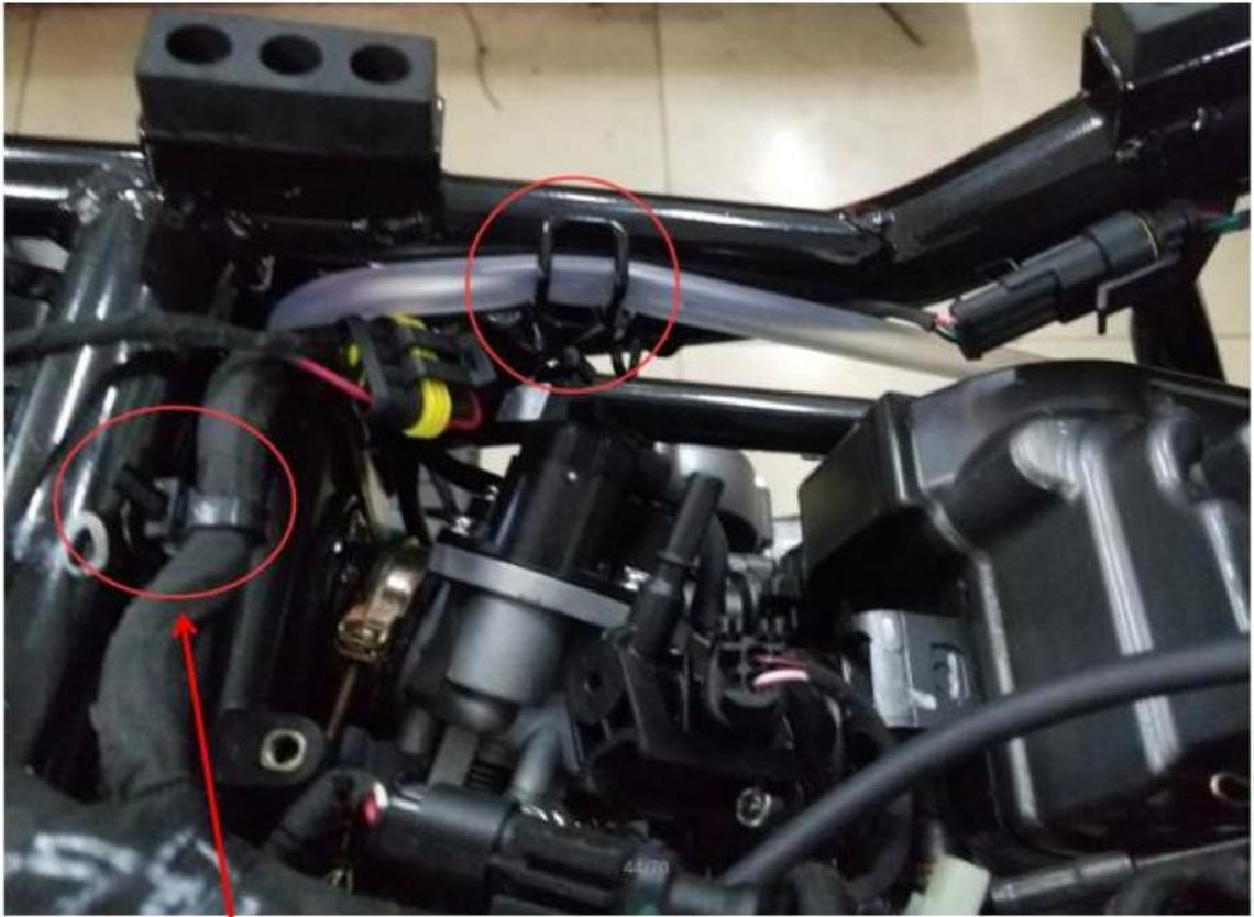
Fije el cable principal en el tubo rígido del chasis usando cintas de fijación
