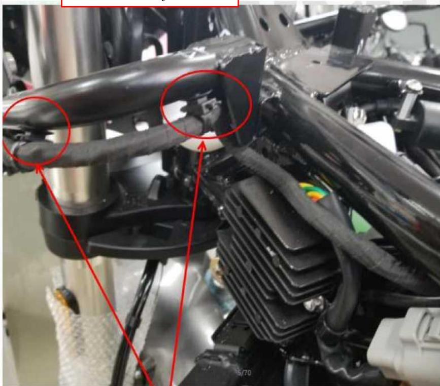
Coloque el cable principal a lo largo del lado izquierdo del soporte del faro
