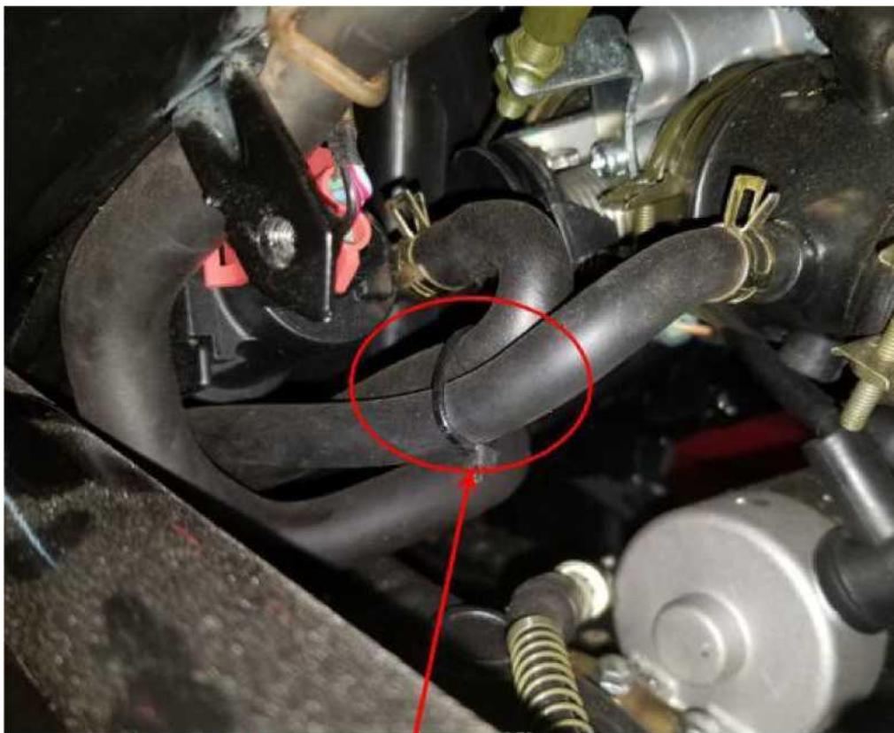
Fijar las mangueras de aceite con cintas de sujeción
