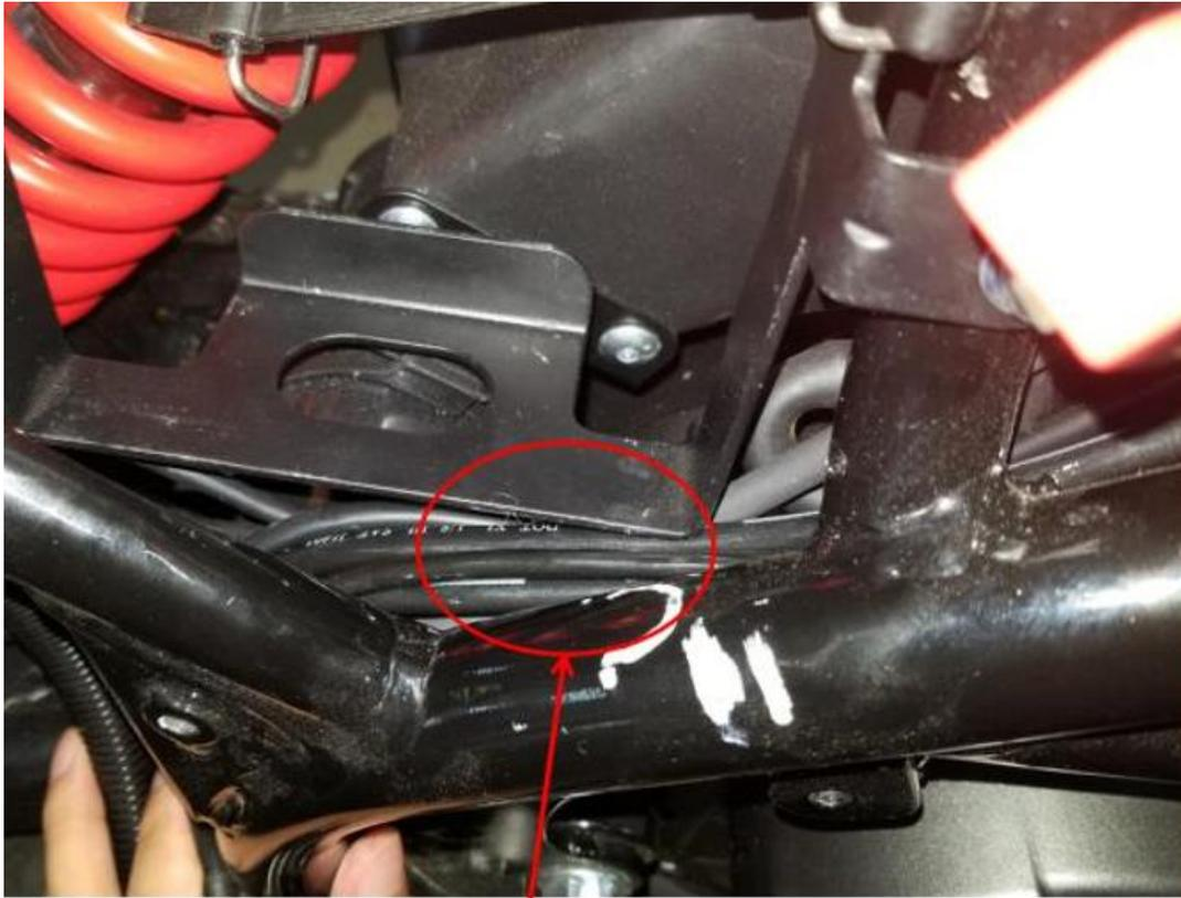
Fije el conector ABS con cintas de sujeción
