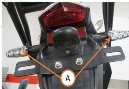
Desmonte la luz direccional trasera izquierda [A] y la luz direccional trasera derecha [B] (en caso de tener maleta lateral).
