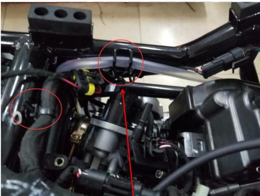
Fijar la tubería de agua que gotea en la abrazadera del marco
