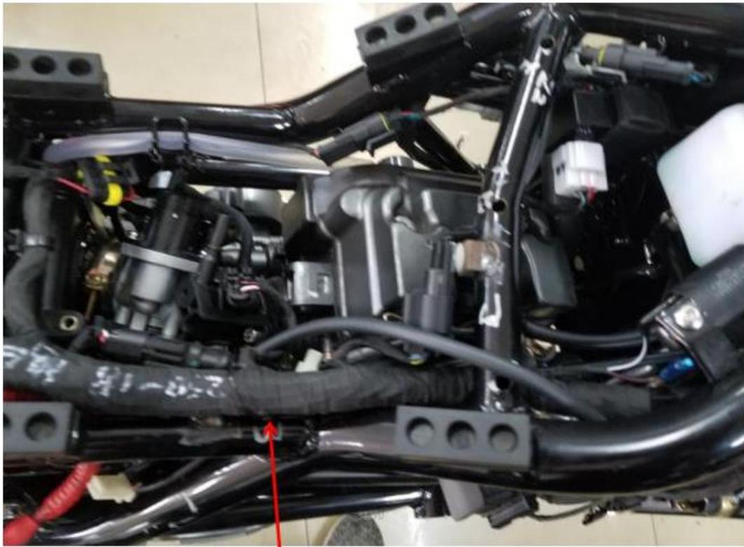
Coloque el cable principal a lo largo del lado izquierdo y fíjelo con el cable principal utilizando cintas de fijación.
