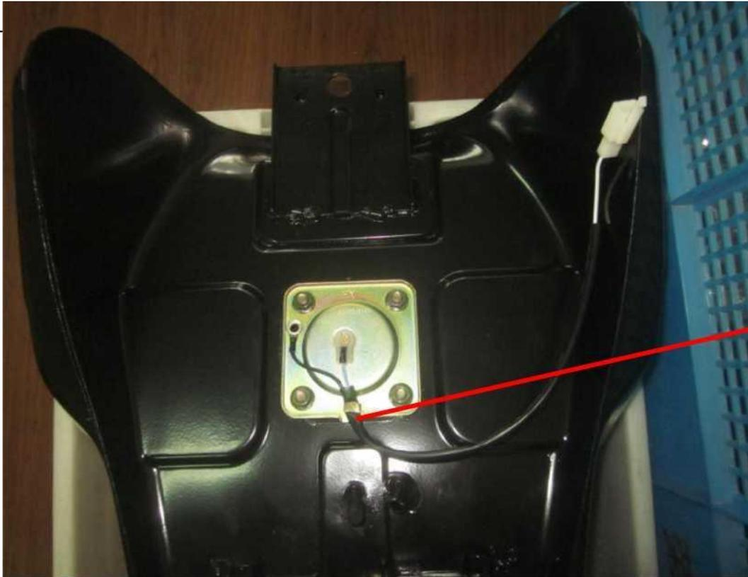
La dirección de instalación del sensor de nivel de combustible se muestra en la figura
