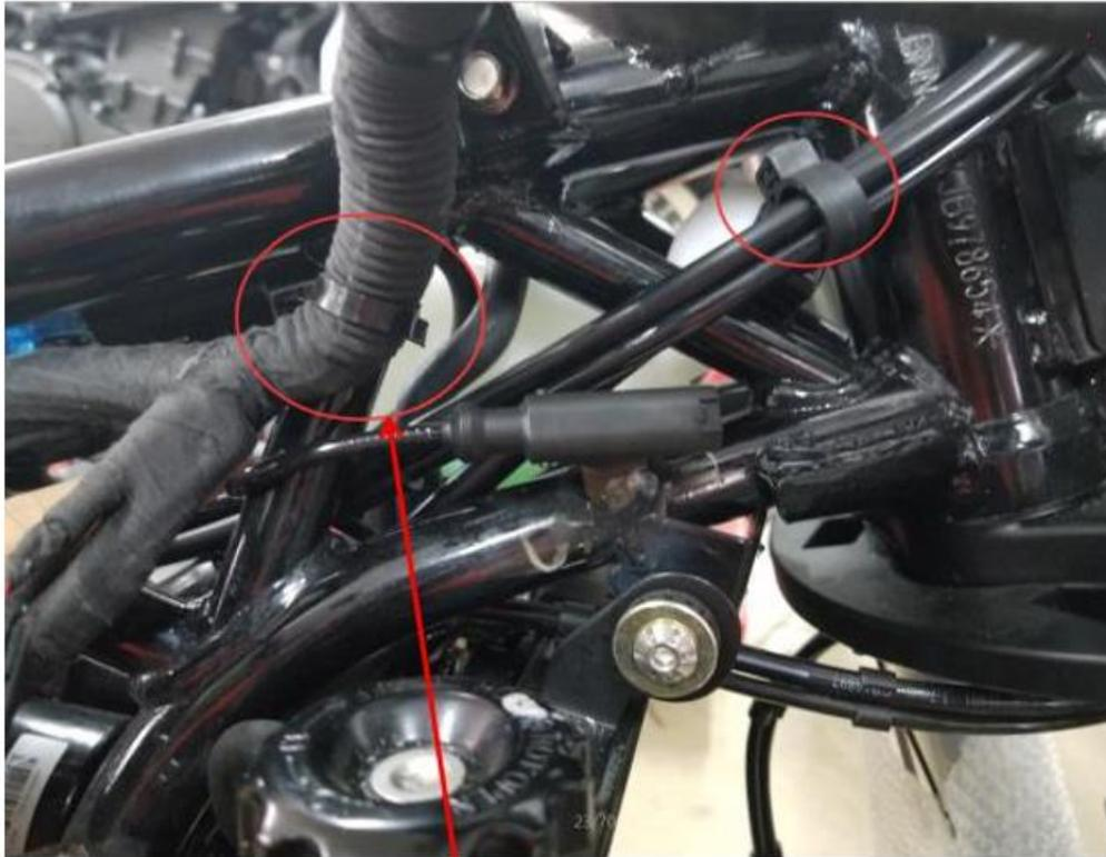
Coloque el cable principal a lo largo de la derecha del soporte del faro y fíjelo utilizando cintas de fijación; ir al interior del marco desde el trípode del marco derecho
