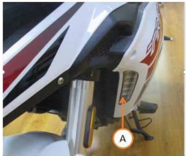
Desmonte la luz direccional delantera derecha (para más detalles, véase "Chasis" - "Desmontaje del panel delantero derecho").
