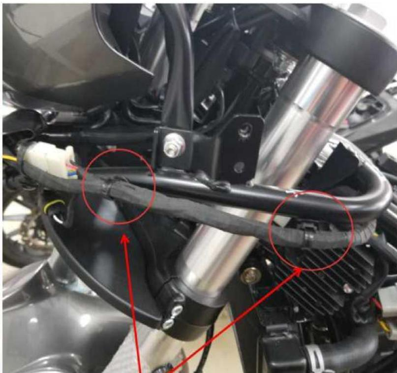
Coloque el cable principal a lo largo del lado izquierdo del soporte del faro y fíjalo utilizando cintas de sujeción
