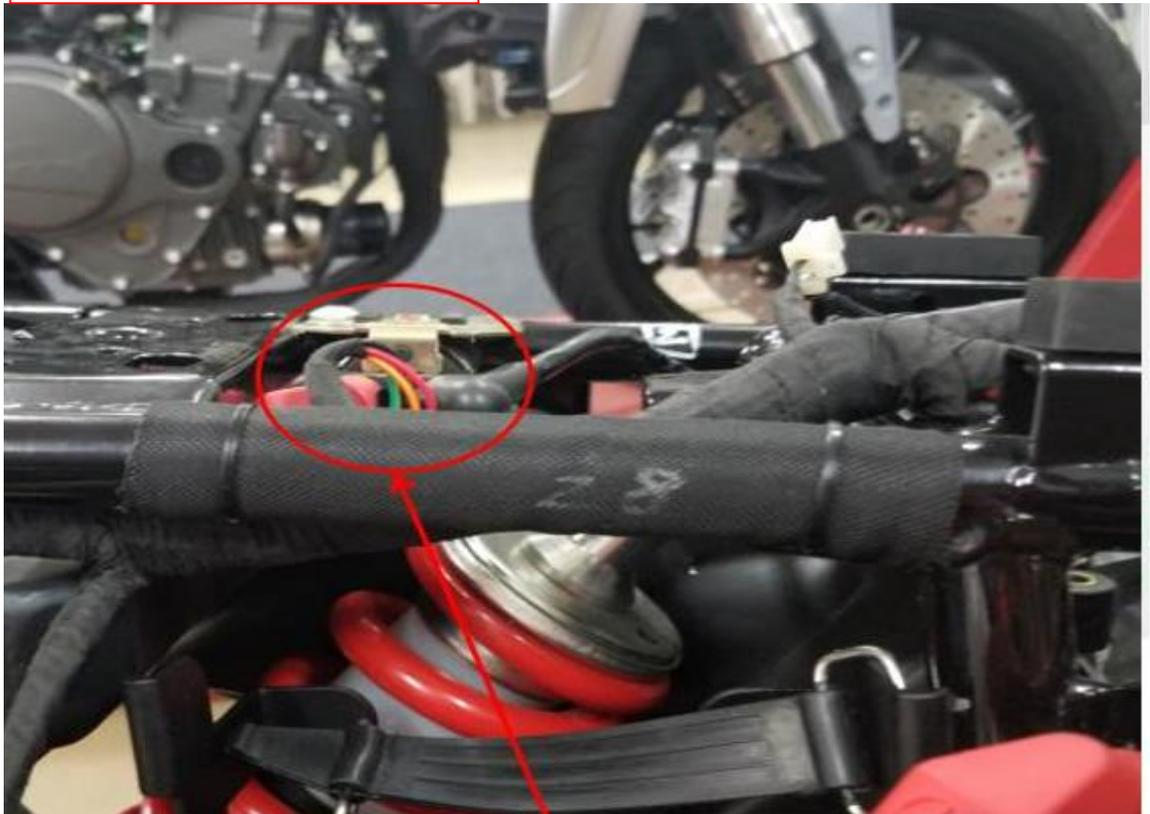
Evite que los electrodos positivo y negativo de la batería entren en contacto con el chasis
