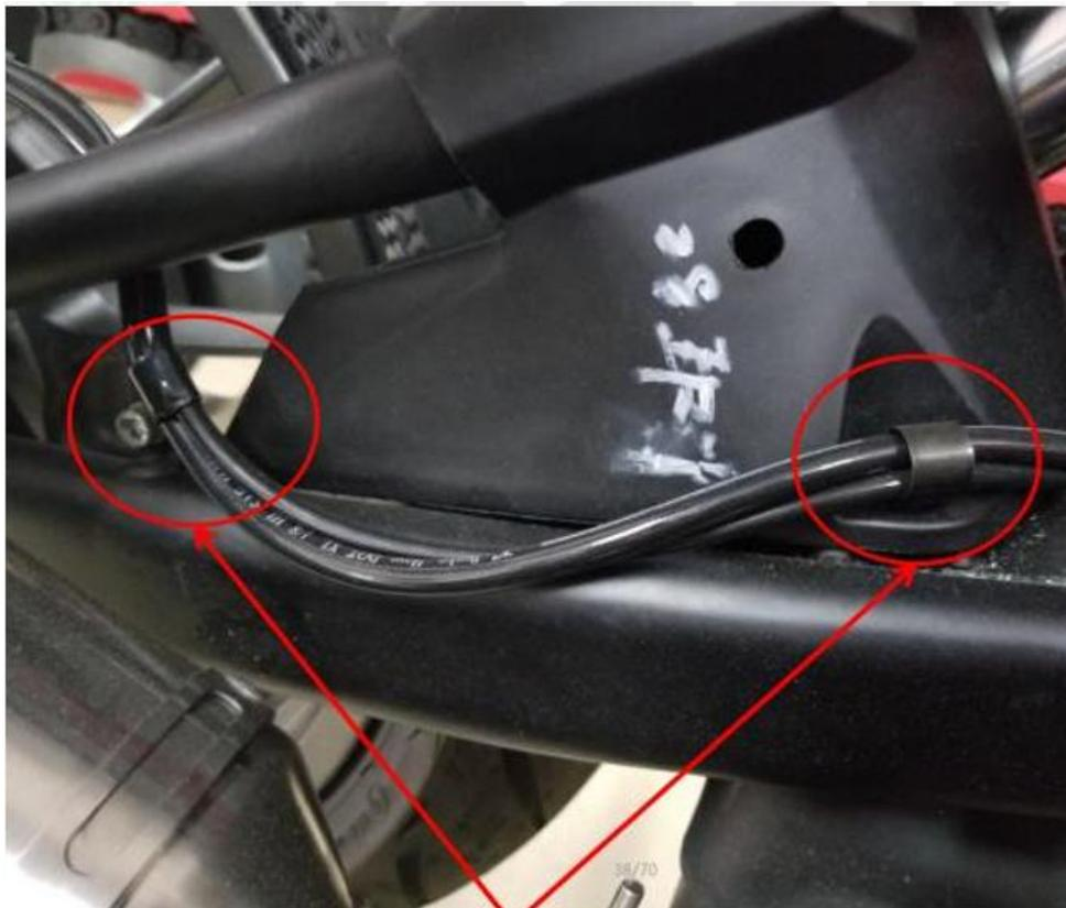
Fije la manguera de freno usando cintas de sujeción, vaya a la parte interna del chasis desde el lado derecho del trípode del chasis.
