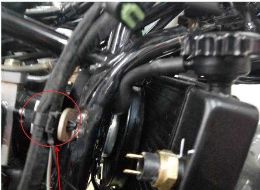
Fije el conector ABS con cintas de sujeción
