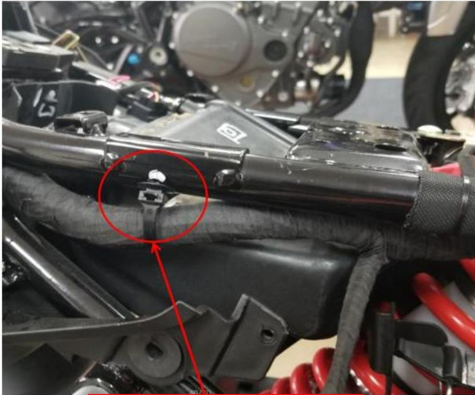
Coloque el cable principal a lo largo del lado derecho inferior del chasis y fíjelo utilizando cintas de fijación.
