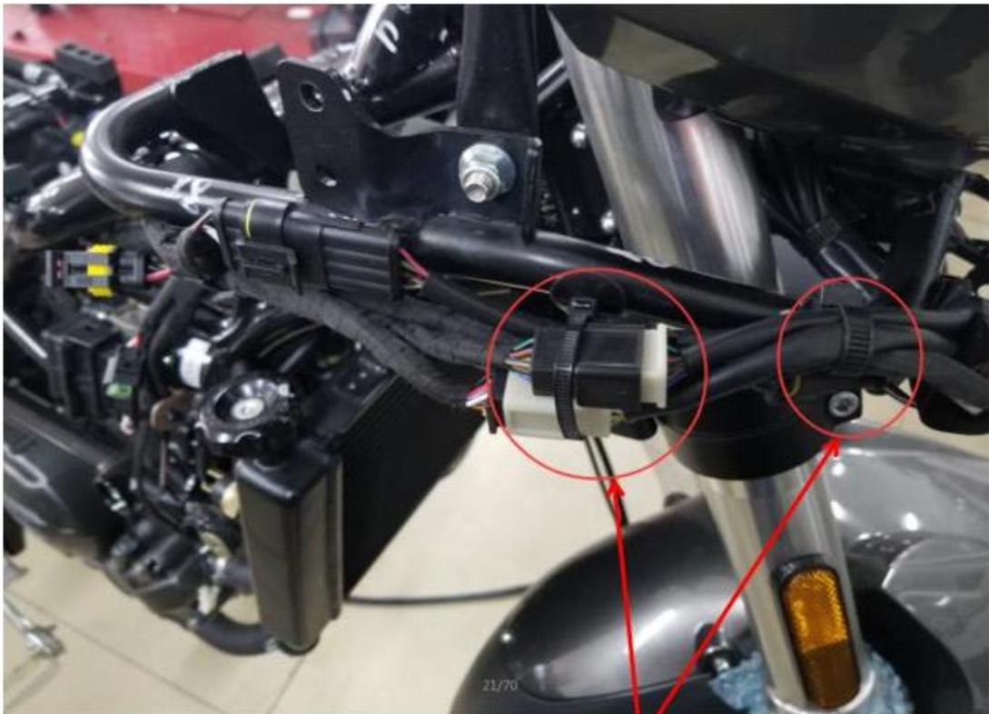
Coloque el cable principal a lo largo del lado derecho del soporte del faro y fíjelo utilizando cintas de fijación.
