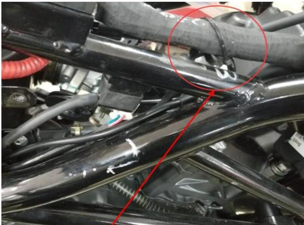
Coloque el cable principal a lo largo del lado derecho del chasis y fíjelo con el cable principal utilizando cintas de fijación.
