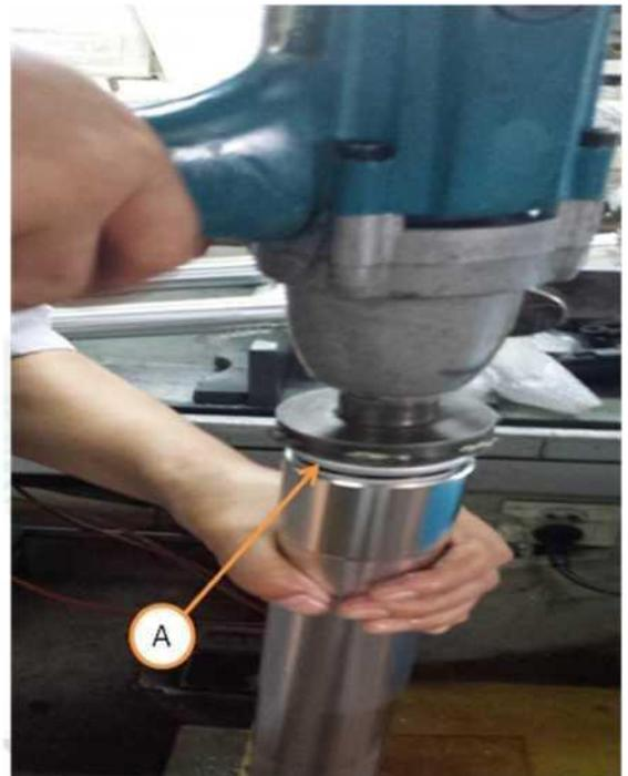
Instale la herramienta de fijación [A], como se muestra en la figura
