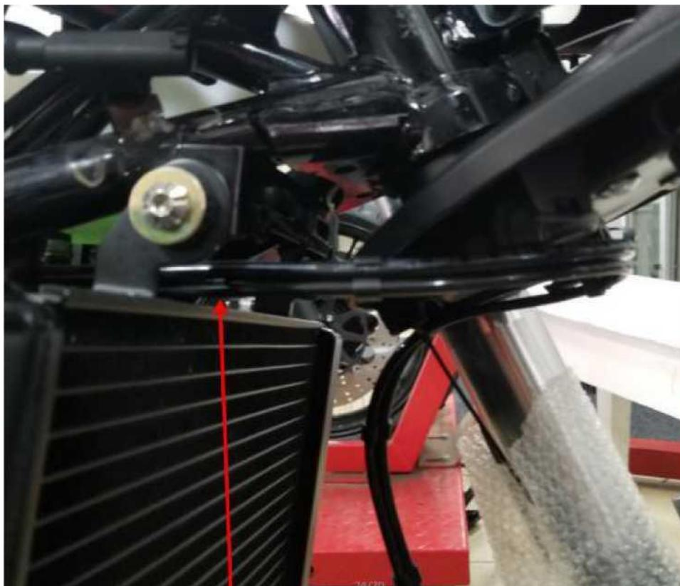
Disponga la tubería del aceite de ABS a lo largo del lado interno del tanque de agua.
