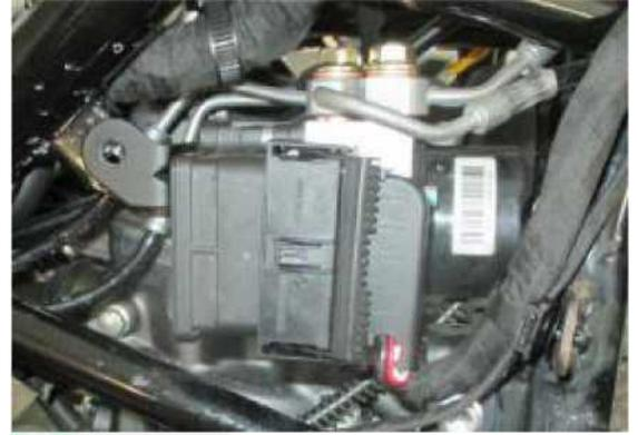
**Instale el mecanismo hidráulico del ABS**
